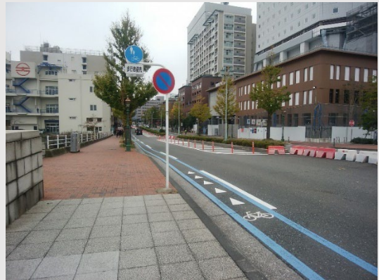
パーキングメーターの撤去による 自転車専用通行帯の整備（中区）
